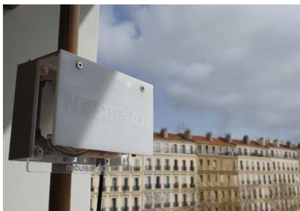
Figure 1 - Capteur Nebuleair installé au barreau d'une fenêtre, sans la cellule NO 2
